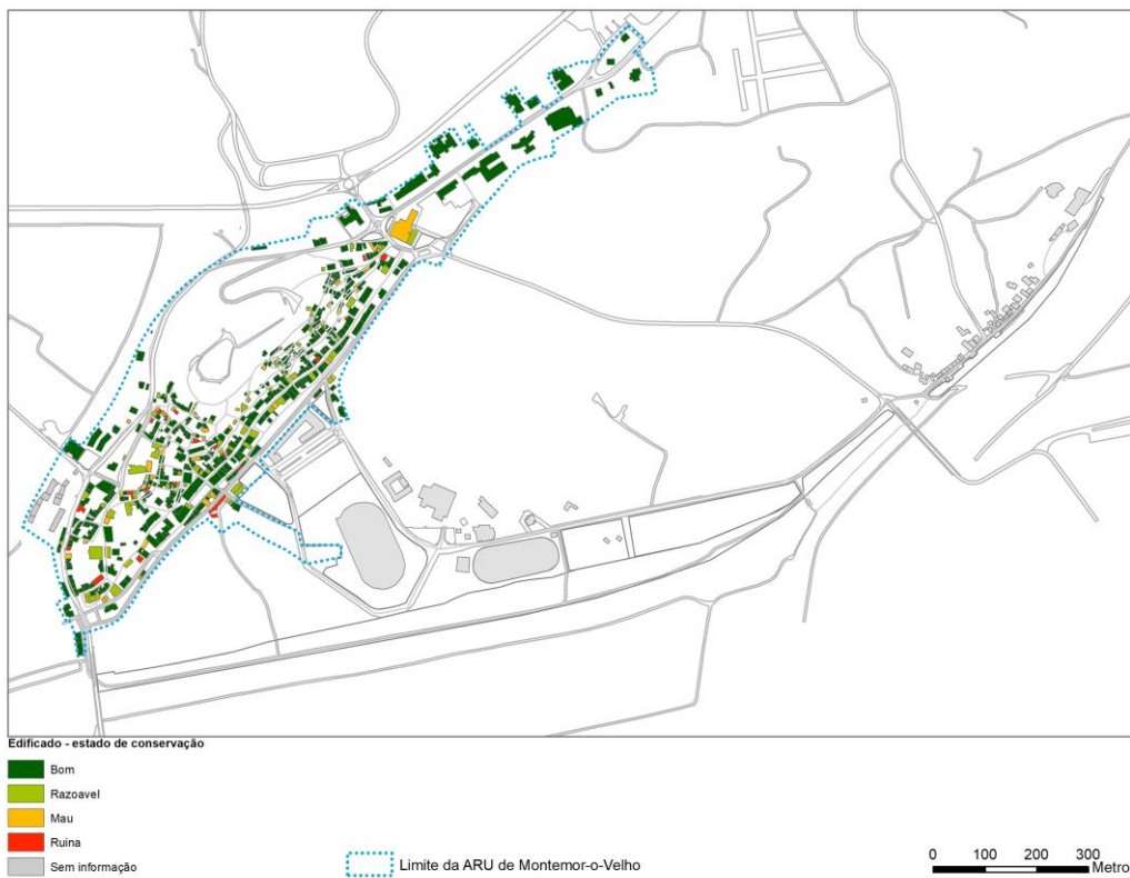
Figura 33. Estado de conservação do edificado da ARU da Vila de Montemor-o-Velho
