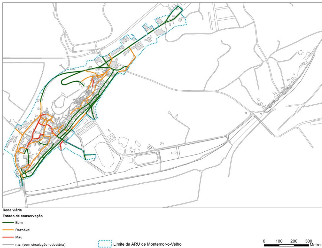
Figura 48. Estado de conservação da rede viária da ARU da Vila de Montemor-o-Velho
